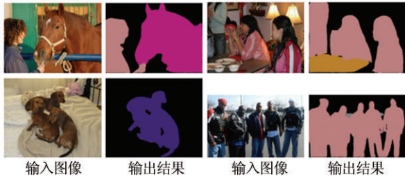
图 17 DeepLab-v3+ 模型图像分割效果 [33]
