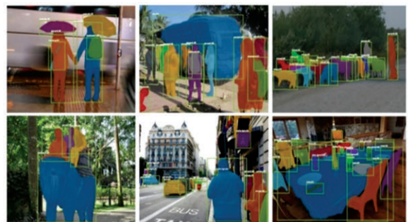
图 19 Mask R-CNN 模型图像分割效果 [34]
